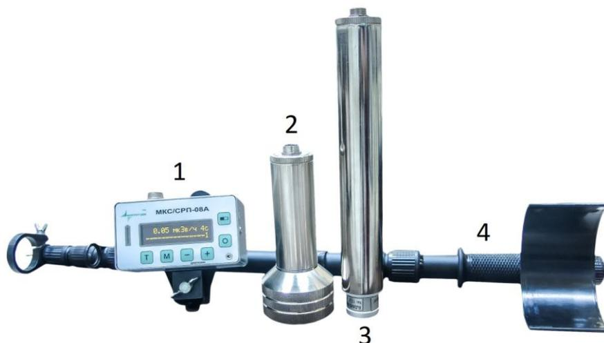
Рис. 6. Внешний вид поискового дозиметра-радиометра МКС/СРП-08А.
