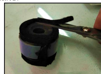
Рисунок 8. Обработка внешних краев теплоизоляционного материала.
