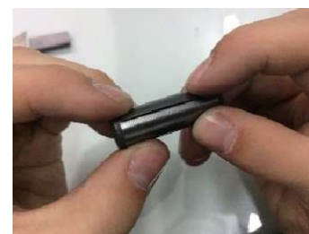
Рисунок 10. Накрутка бумаги на пуансоны
