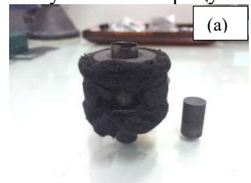
Рисунок 11. Вставка пуансонов с графитовой бумагой в матрицу
