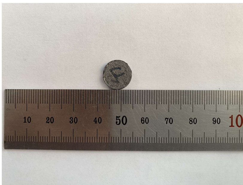
Рисунок 15. Характерный внешний вид образцов Ø12мм после ЭИПС.
