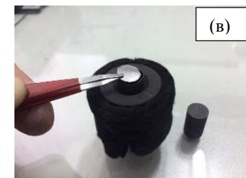
Рисунок 12. Установка графитовых шайб в матрицу
