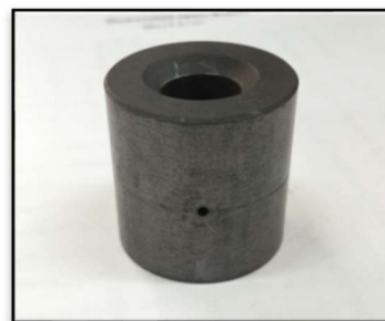
Рисунок 4. Глухое отверстие под термопару
