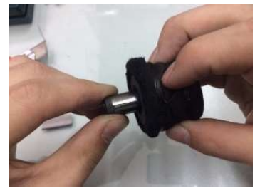
Рисунок 11. Вставка пуансонов с графитовой бумагой в матрицу
