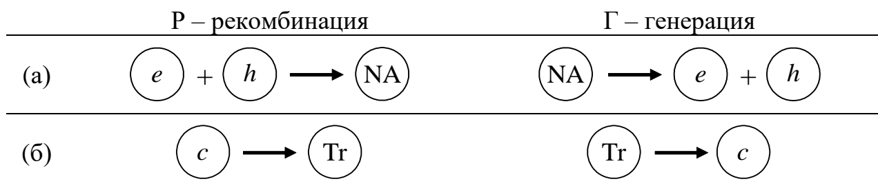
Рис. 4.1. Генерационно–рекомбинационные процессы: (а) одноступенчатая (прямая) генерация–рекомбинация; (б) процесс с участием ловушки.
