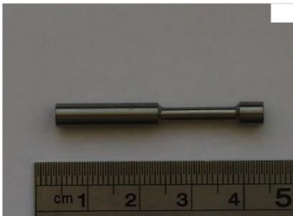
Рисунок 21 – Фотография образца титанового сплава для испытания на усталость
