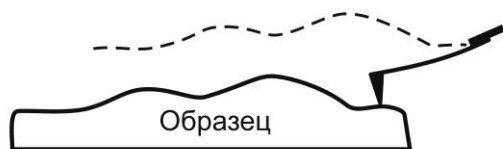
Рисунок 8. Схема движения кантилевера в методике постоянной силы взаимодействия между зондом и поверхностью
