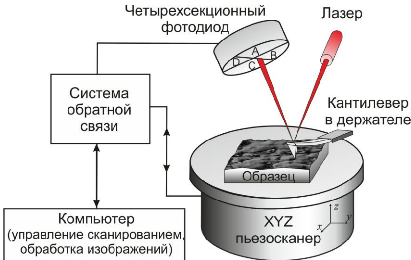
Рисунок 7. Схематическое изображение АСМ
