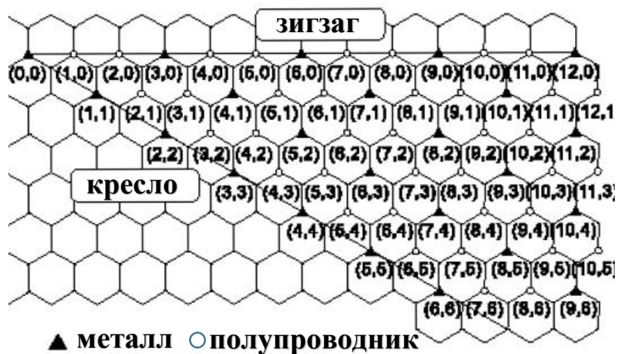
Рисунок 5. Схема индексирования вектора решетки C_h .
