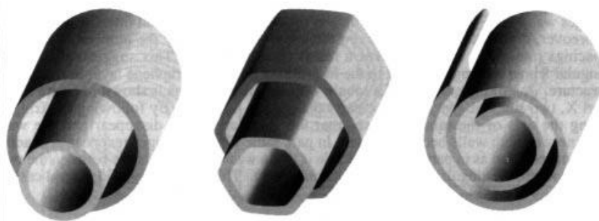
Рисунок 6. Модели поперечных структур многослойных нанотрубок: «матрешка» (а); шестигранная призма (б); свиток (в) [3].
