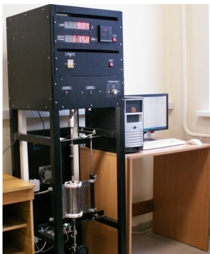
Рис. 13 Измерительно-вычислительный комплекс (ИВК) для механических испытаний на ползучесть и длительную прочность. Общий вид
