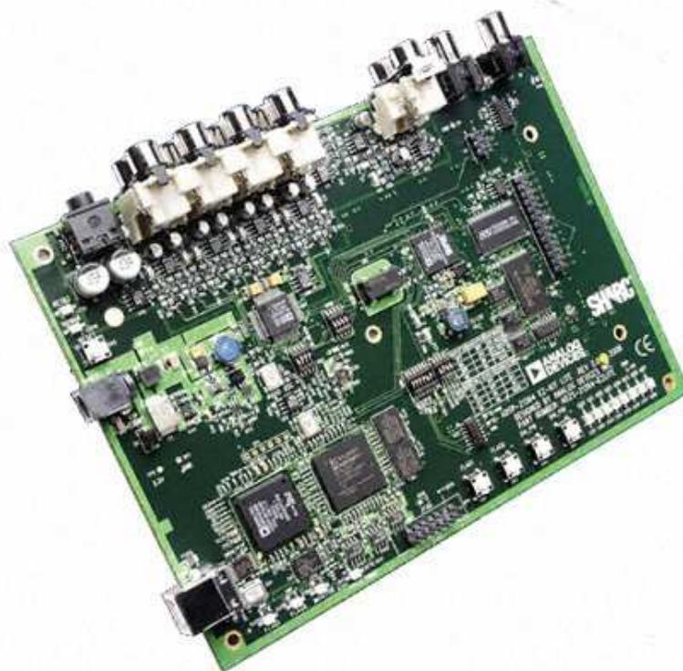
Рис. 4.2. Отладочная плата сигнального процессора ADSP-21364
