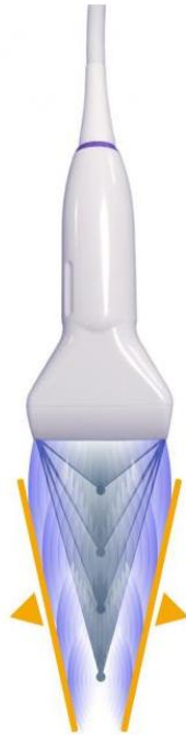
Рис. 1.4.21. Иллюстрация способа возбуждения сдвиговых волн в сканере Aixplorer®
