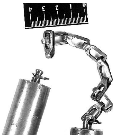
Изображение 2. Разрыв цепочки в процессе проведения испытаний.
