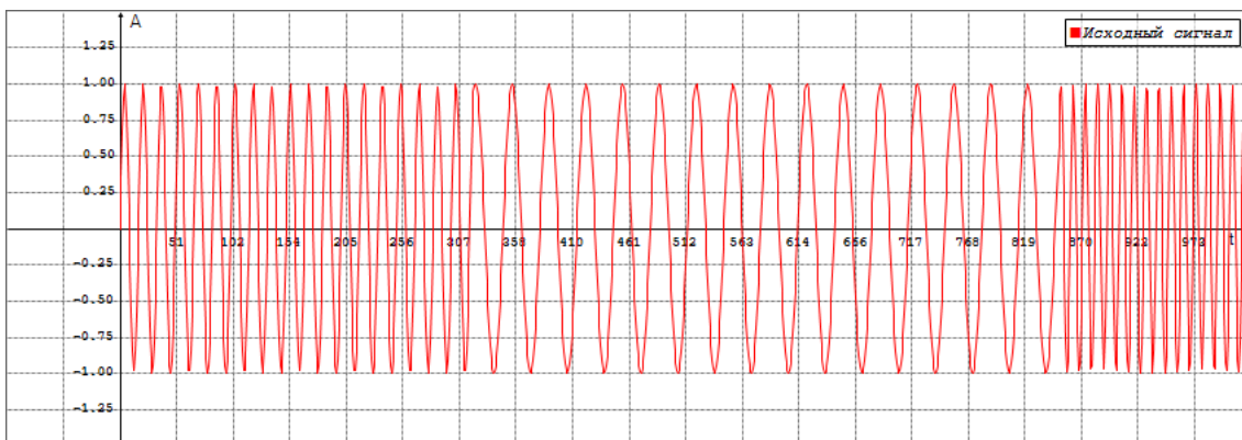
Рис. 8. Исходный синусоидальный сигнал с параметрами N = 1024 , n_1 = 320 , n_2 = 850 , f_0 = 0.03 , f_1 = 0.06 и f_2 = 0.09
