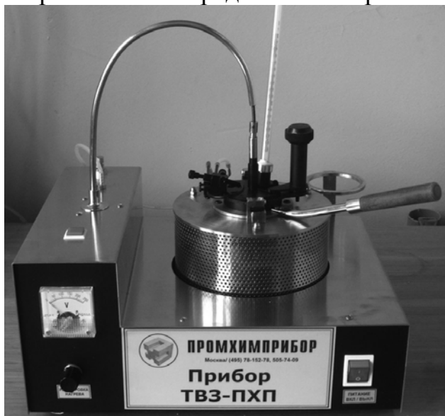
Рис. 4.6. Прибор для определения температуры вспышки в закрытом тигле - ТВЗ.
