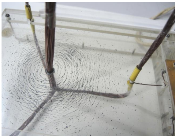
Рис. 3. Круговое поле прямого проводника с током
