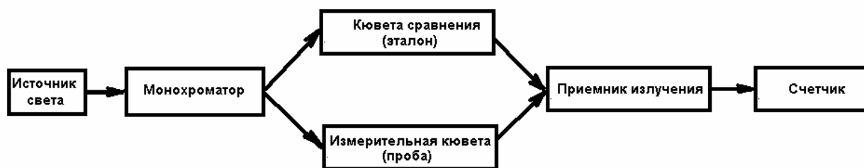
Рис. 6. Схема устройства для измерения спектров поглощения.
