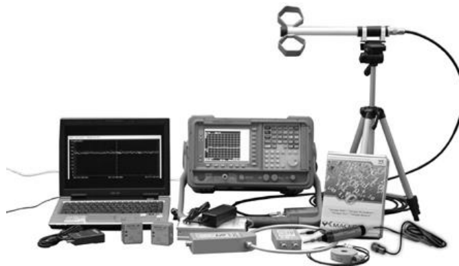
Рис. 13. Система оценки защищенности по каналу ПЭМИН «СИГУРД»
