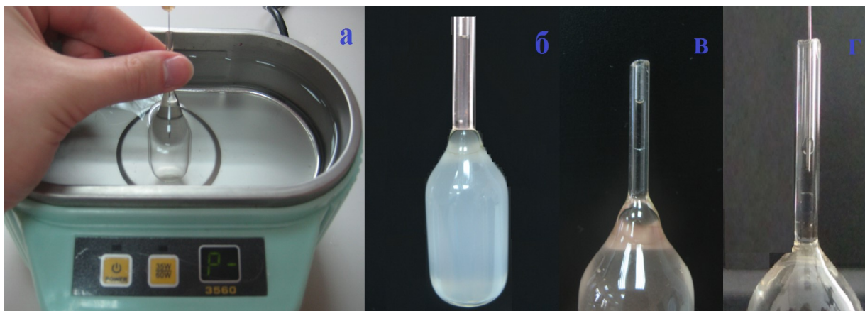
Рис. 3.12. Схема проведения концентрирования с ультразвуковым диспергированием экстрагента (а – ультразвуковое диспергирование экстрагента, б – образовавшаяся эмульсия, в – полученный после центрифугирования экстракт, г – отбор экстракта микрошприцем для газохроматографического анализа) [145]
