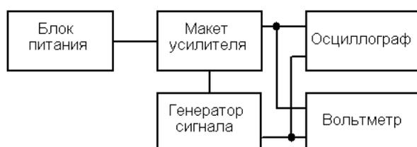
Рис. 32. Блок-схема измерительной установки
