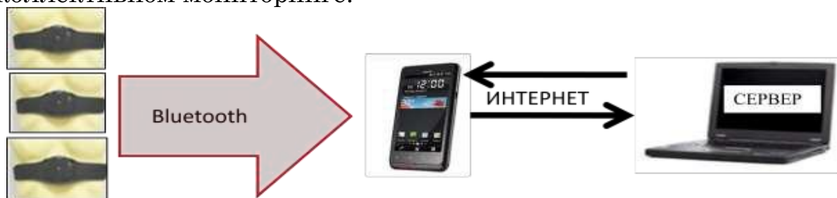
Рис. 1. Схема беспроводной регистрации кардиосигнала
