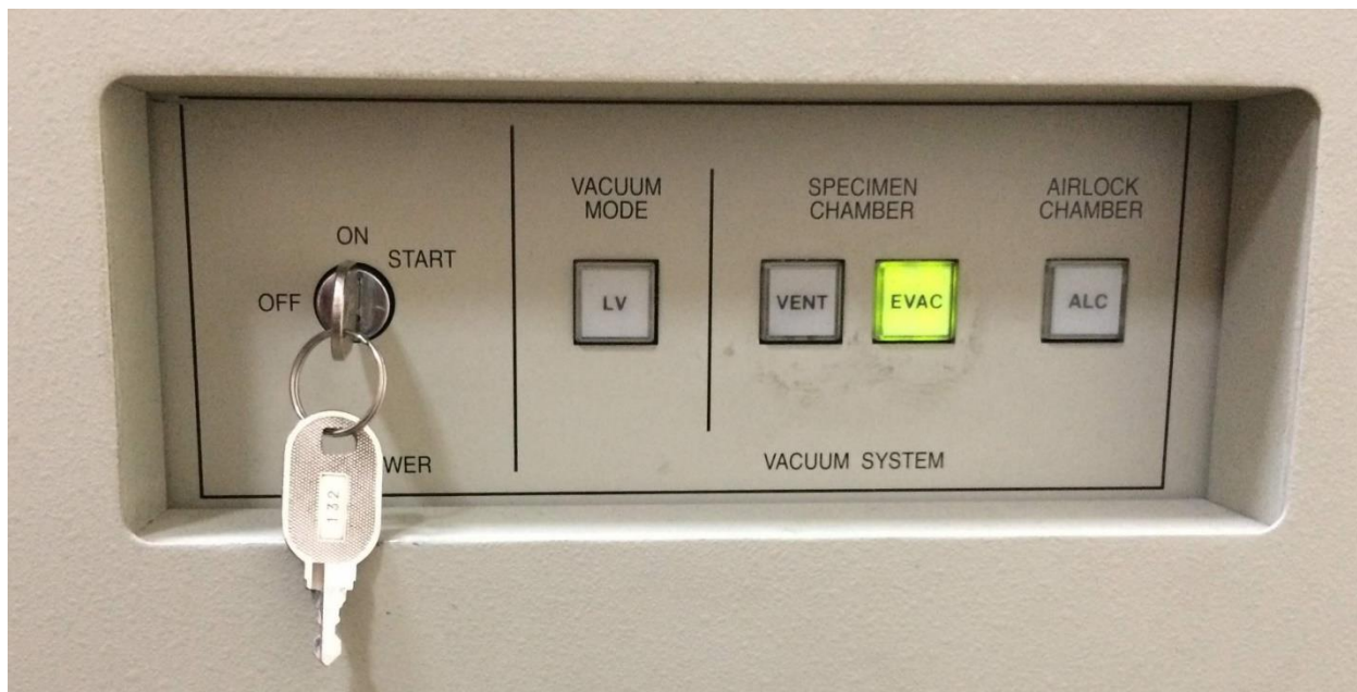
Рисунок 6.6 – Увеличенное изображение ключа для запуска микроскопа и кнопок управления вакуумной системой
