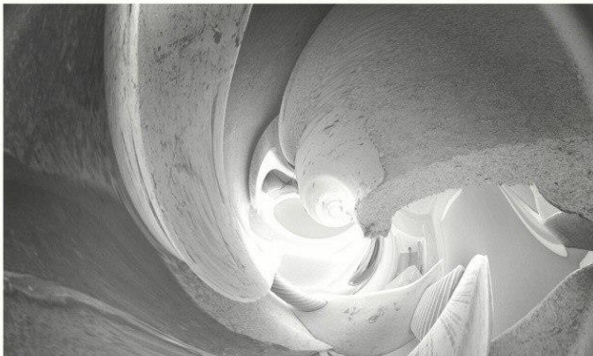
Рисунок 19 – Сильное искажение изображения вследствие искривления траектории электронов магнитным полем образца. Объект исследования – неодимовый магнит
