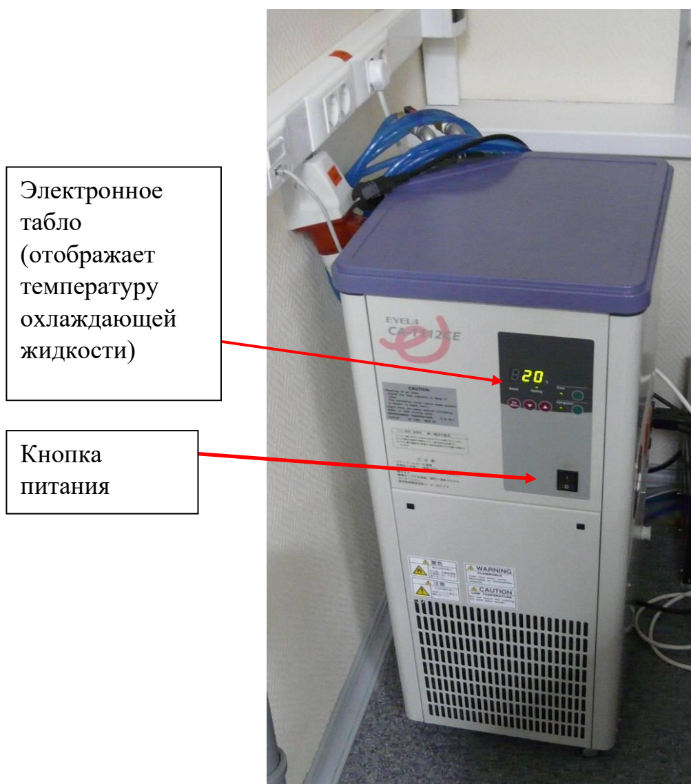
Рисунок 5.3 – Внешний вид системы охлаждения
