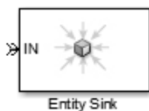
Рис. ПЗ.21. Блок завершения путей сущностей
