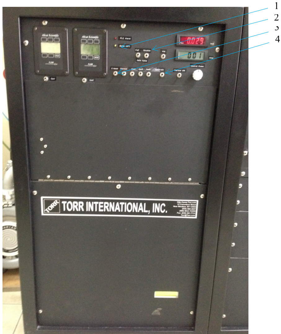
Рисунок 2.7. – Блок управления клапанами и блок управления турбомолекулярным насосом TORR International.
