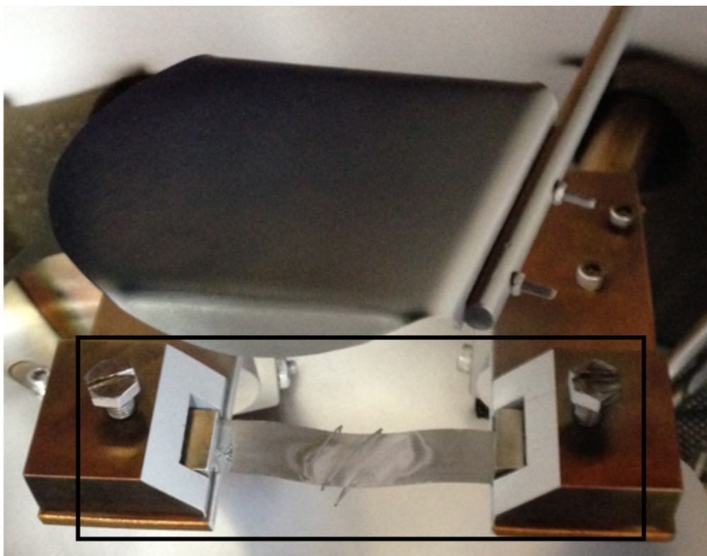
Рисунок 2.9. – Фотография элемента вакуумной установки с испарителем для резистивного нагрева мишени (выделенная область).
