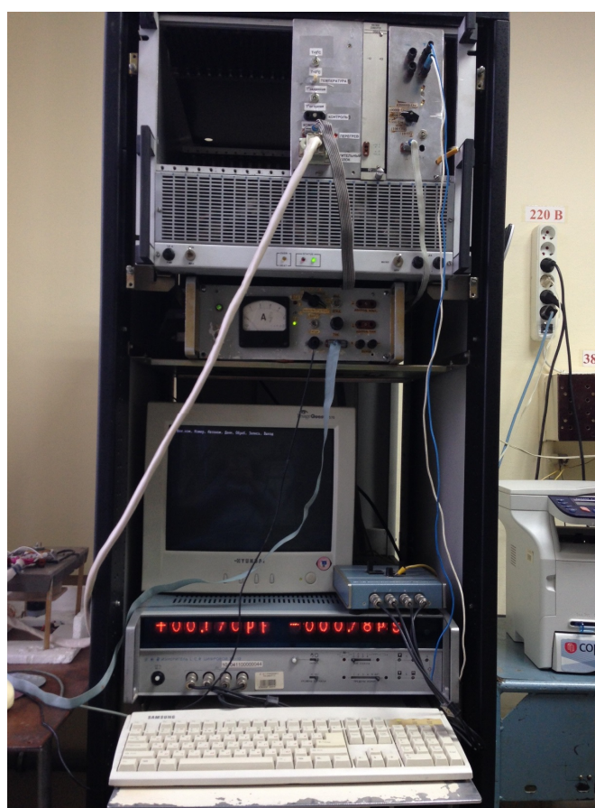
Рисунок 3.2. – а) Лицевая панель измерителя токов и напряжений Keithley 2400; б) Установка для измерения ёмкости на базе измерителя E7-12.
