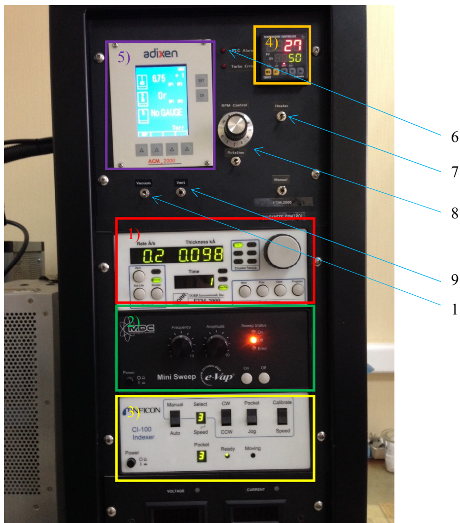
Рисунок 2.5. – Верхний блок электроаппаратуры установки вакуумного напыления TORR International.
