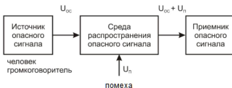
Рис. 5. Схема канала утечки речевой информации
