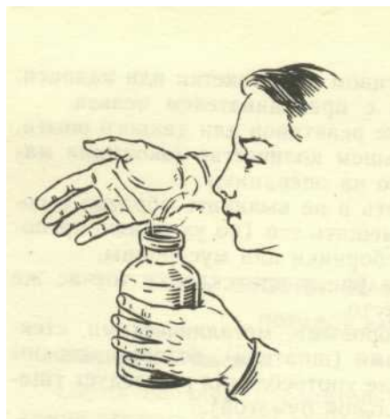
Рис. 1. Определение запаха газа. При определении запаха газа или жидкости нельзя низко наклоняться над сосудом с собранным газом или подносить его близко к лицу. Ток газа с воздухом слегка направлять рукой к себе и осторожно вдыхать его смесь с воздухом.
