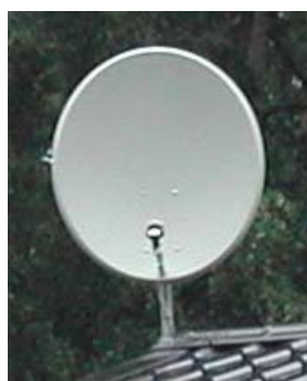
Рис. 16. Приемная антенна спутникового телевидения Ku-диапазона (11ГГц).
