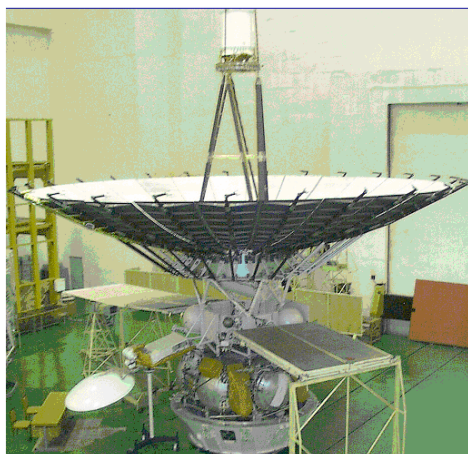
Рис. 23. 10-метровая складная космическая антенна проекта «Радиоастрон» во время наземных испытаний в НПО им. С.А.Лавочкина, г.Химки, Московской обл.
