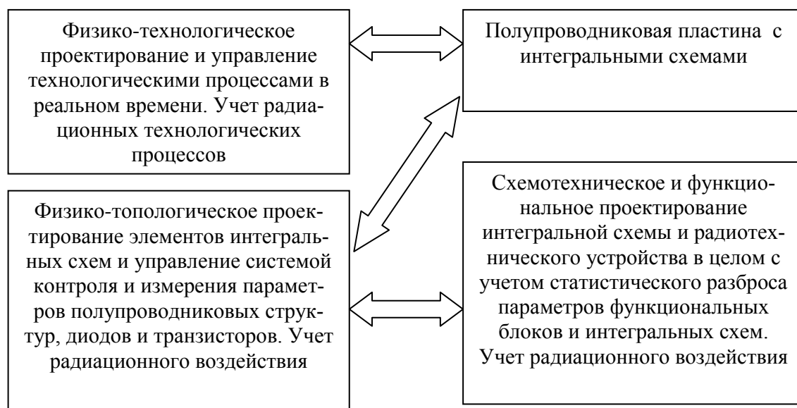
Рис. 2.2. Схема проектирования полупроводниковых диодов, транзисторов и интегральных схем
