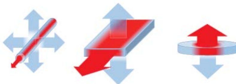
Рис. 1. Геометрии активных элементов для лазеров высокой средней мощности: тонкий стержень, тонкий слэб и тонкий диск. Красные стрелки показывают направление распространения излучения, а синие – направление отвода тепла.
