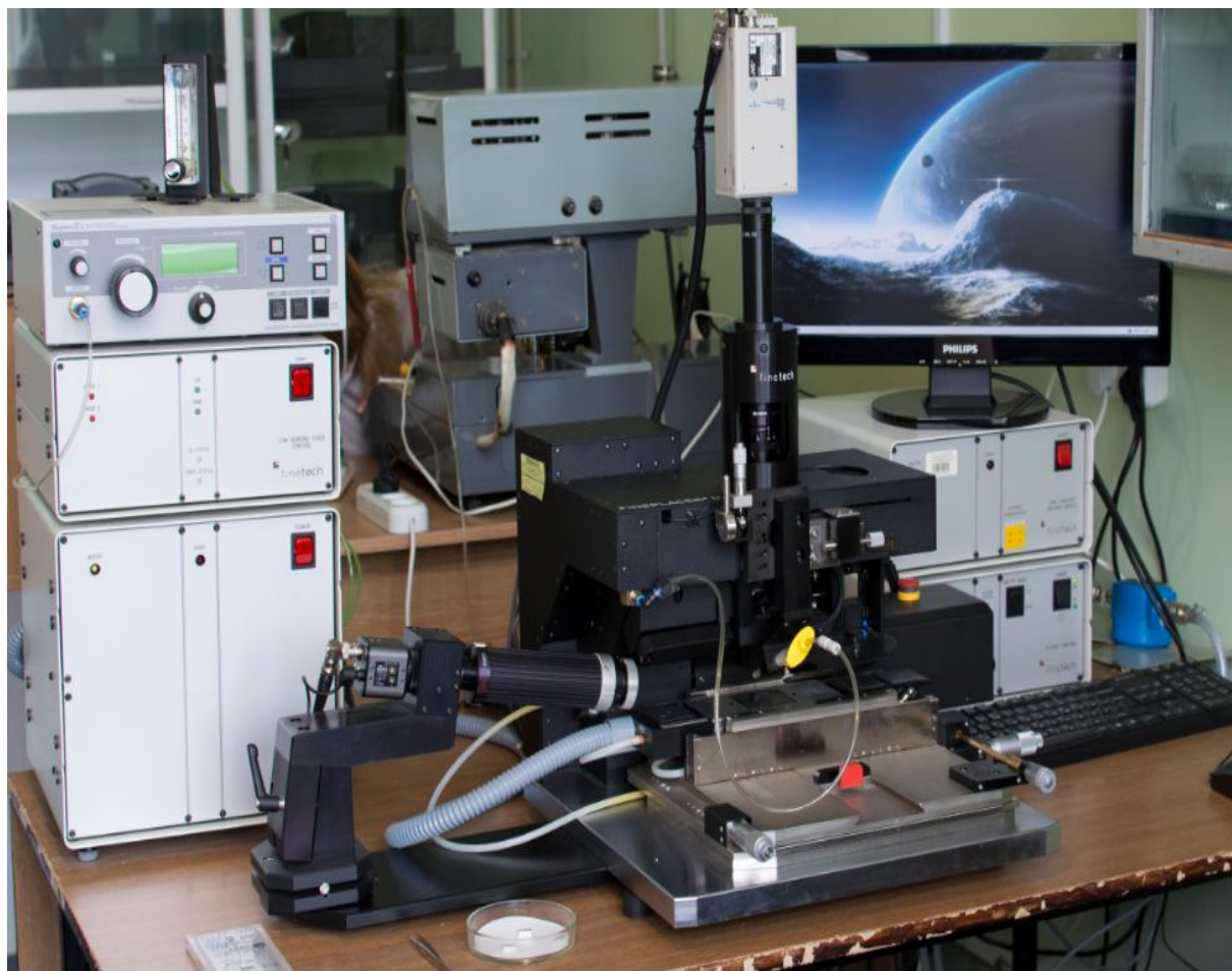
Установка сверхточного монтажа Fineplacer lambda-96
