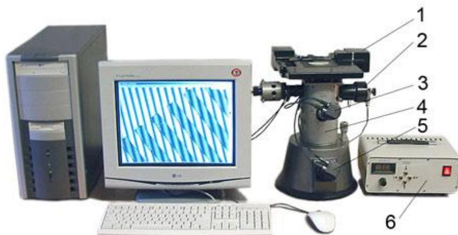
Рис. 5. Автоматизированный интерференционный микроскоп.
