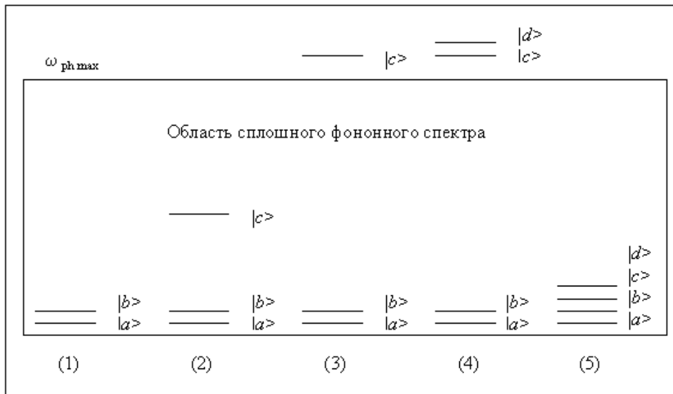
Рис.1.3.16 Диаграмма уровней, участвующих в процессах спин-решеточной релаксации. 1 - прямой процесс; 2 - процесс Орбаха; 3 - двухфононные рамановские процессы, (ион с четным числом электронов); 4 - ион с нечетным числом электронов; 5 - процесс Блюма-Орбаха.
