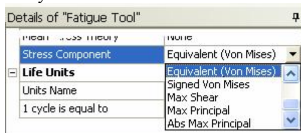
Рис. 20. Задание метода учета сложного напряженного состояния
