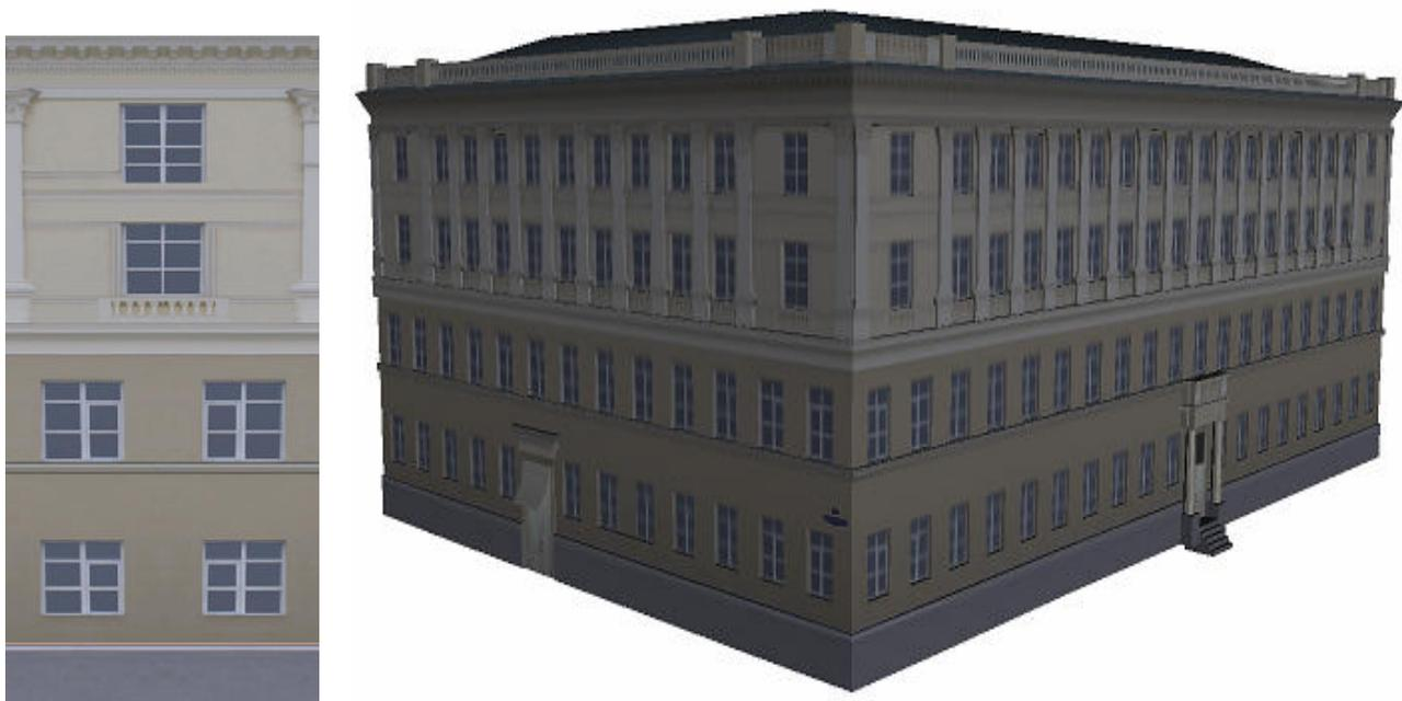
Рис. 2.14. Бесшовная текстура и пример её использования на модели фасада здания
