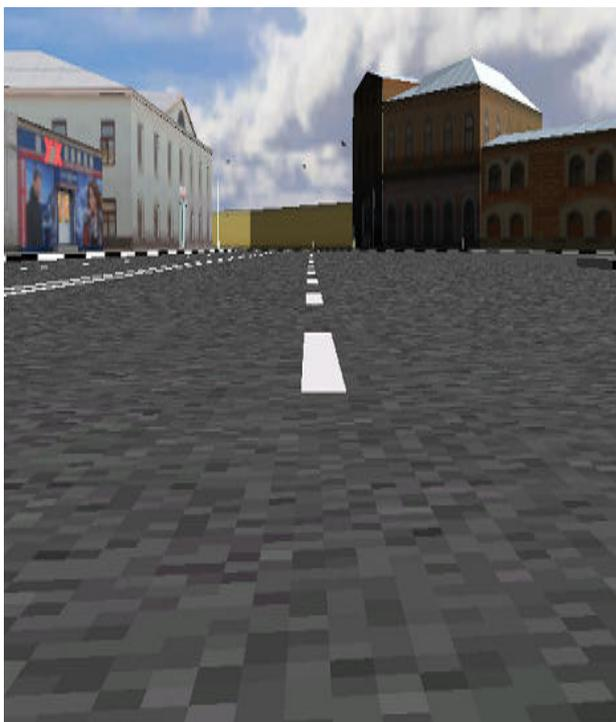
Рис. 2.16. Формирование изображения без фильтрации текстур
