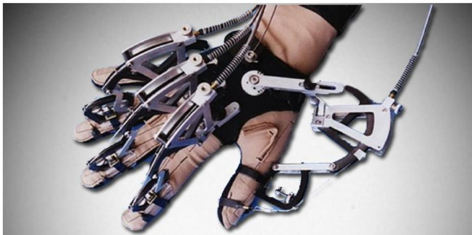
Рис. 4.3. Первая коммерческая перчатка виртуальной реальности «*Dataglove*» (изображение взято с сайта <http://www.cs.ru.ac.za>)
